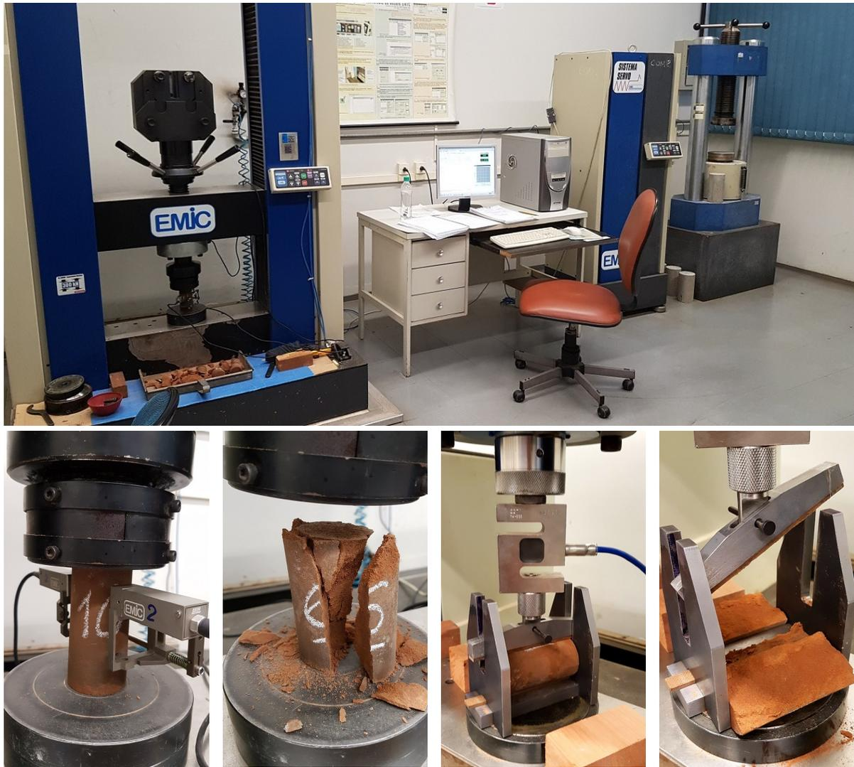
Figura 3 - Sala de ensaios de resistência de materiais de construção civil na FEB/UNESP-Bauru. Ensaio de laboratório visando a futura revisão das normas para solo-cimento, com corpos de prova de  $\phi$  5 cm e h=10 cm: determinação de módulo de deformação, resistência à compressão e resistência à tração por compressão diametral (Crédito: Obede B. Faria)
