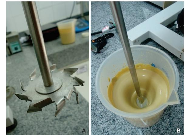
Figura 3 – Disco *cowles*. A: Modelo adaptado pelo projeto Cores da Terra; B: Disco *cowles* em pleno funcionamento (Crédito: Fernando de Paula Cardoso)
