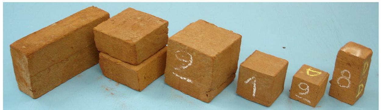
Figura 1 - Moldes de madeira e corpos de prova dos Ensaos Interlaboratoriais PROTERRA: (a) Adobe de 7,5 cm x 15 cm x 30 cm; (b) Cubos de 10 cm; (c) Cubos de 15 cm (Crédito: Obede B. Faria, 2008)
