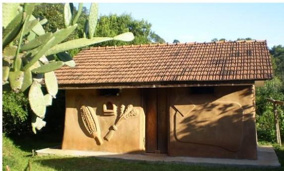
Figura 6 - Casa de sementes, com parede externa de terra ensacada; parede interna de taipa de pilão. Autoconstrução, 2002. Projeto: família Giombelli (Crédito: Cecília Prompt)
